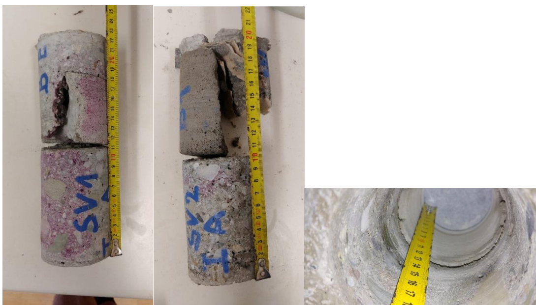
Obr. 21. Složení střešní konstrukce po výšce. V místě vývrtu viditelná 1cm tlustá škvíra mezi ŽB skořepinou a vrchní vrstvou pórobetonu.
