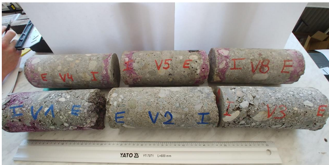
Obr. 27. Porovnání vývrtů ze spodní části dříku - dole vývrty z pásu do 160cm – nahoře vývrty vyšších pater
