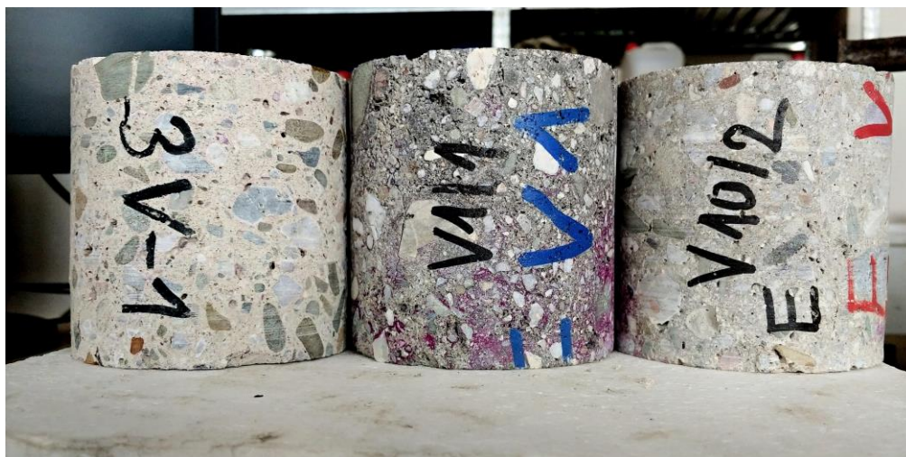
Obr. 26. Barevnost cementového kamene u reprezentativních vzorků betonu (po zkoušce pevnosti v tlaku) odebraných v různých výškách dříku. Zleva: z 1.PP, PŘÍZEMÍ (do 160cm) a z 2.NP.
