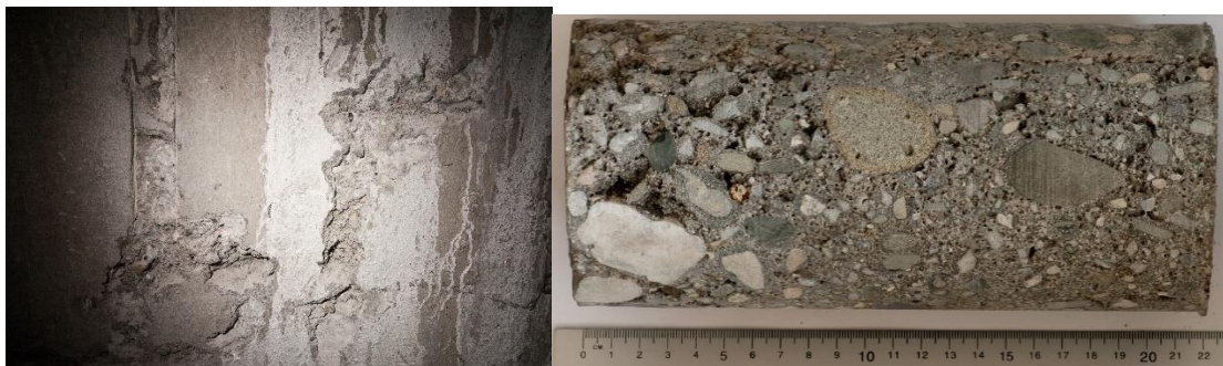
Obr. 7. Sekaná povrchová sonda v pásu 10-150mm (vlevo) a (vpravo) příklad vzhledu betonu v celé tloušťce konstrukce ve spodní části dříku (do 160cm výšky).
